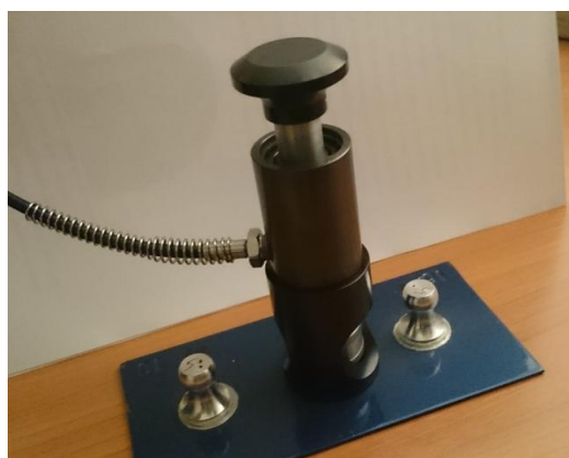
Rys. 9. Uchwyt stosowany do odrywania stempli
