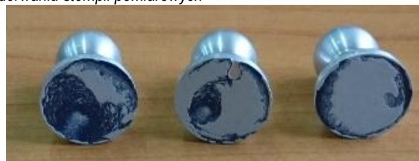
Rys. 11. Widok podstawy stempli pomiarowych po oderwaniu od powierzchni badanej próbki
