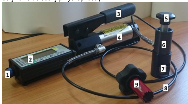
Rys. 6. Urządzenie do badania adhezji powłok polimerowych (1-port USB do przesyłania danych do komputera PC, 2-wyświetlacz LCD, 3-uchwyt pompy hydraulicznej, 4-pompa hydrauliczna, 5-uchwyt siłownika, 6-zespół siłownika, 7-uchwyt do mocowania stempli pomiarowych, 8-wąż, 9-frez do przecinania powłoki)
