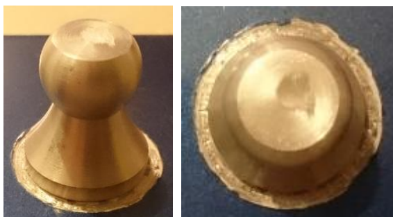
Rys. 8. Stemple pomiarowe przyklejone do powierzchni powłoki polimerowej (naciętej frezem)
