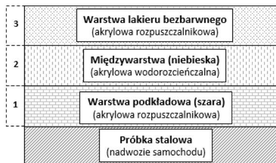
Rys. 2. Struktura trójwarstwowej powłoki akrylowej
