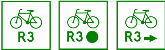
Rys. 1. Oznakowanie międzynarodowych szlaków rowerowych (od lewej znak podstawowy, początku (końca) szlaku oraz zmiany kierunku) [16]
