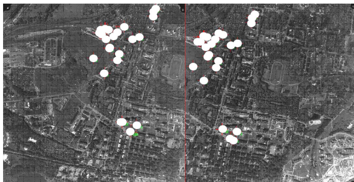
Rys.1. Fragmenty porównywanych zdjęć lotniczych wraz z wyznaczonymi metodą SIFT punktami charakterystycznymi dla obrazu Bytom.
