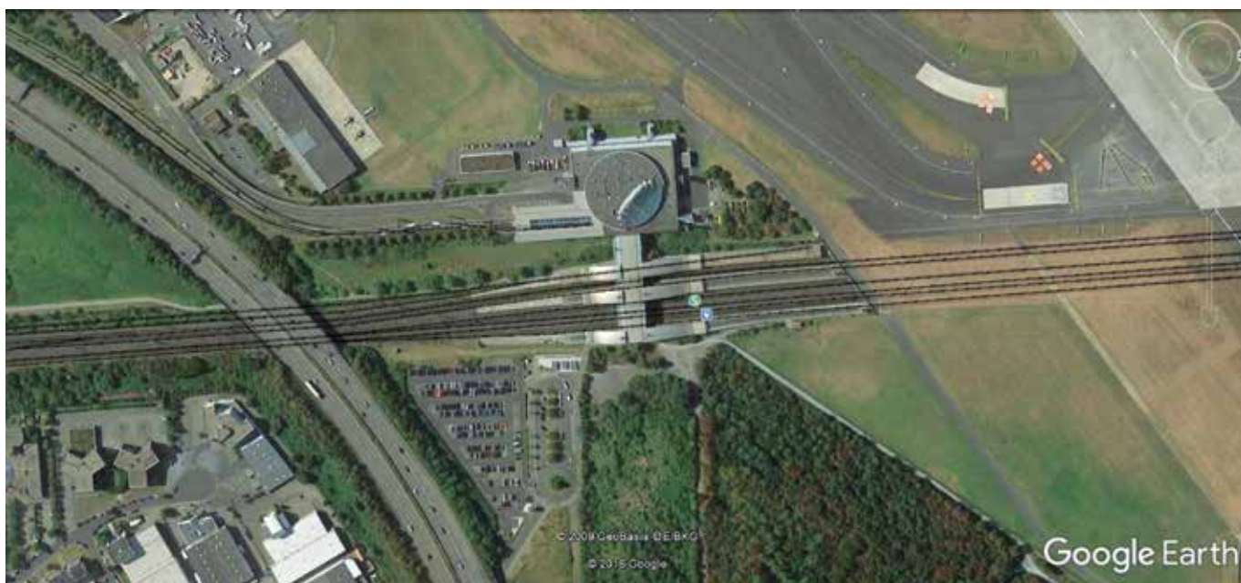
Dworzec Düsseldorf Flughafen. Perony zaczynają się jeszcze w tunelu pod równią lotniskową. Przy dworcu widoczna hala kolei jednoszynowej Źródło: Google Earth, 2016.
