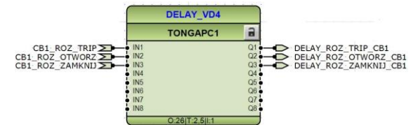
Rys. 6. Funkcja TONGAPC1 realizująca opóźnienie sygnałów sterujących wyłącznikiem [3]
