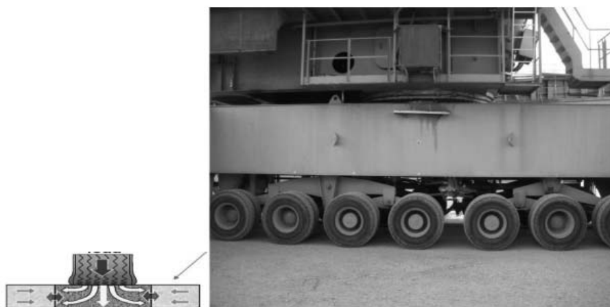
Rys.3. Nawierzchnia nabrzeża z podłożem wzmocnionym kilkoma warstwami geowebu.
