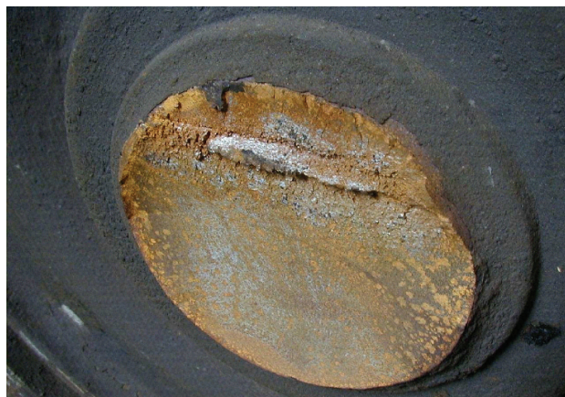
Rys. 8. Uszkodzona oś zestawu kołowego [fot D. Kowalczyk]
