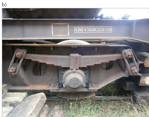
Rys. 1. Zestaw kołowy (a) i zestaw kołowy zamontowany w ramie wózka 1XTa w wagonie towarowym (b) [fot. D. Kowalczyk]
