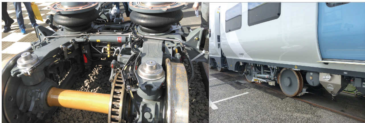
Rys. 3. Wózki z łożyskowaniem wewnętrznym prezentowane na Targach Innotrans 2014 [fot. D. Kowalczyk]
