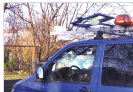
Fot. 14. Urządzenie Sowa-3 do półautomatycznej oceny nawierzchni jezdni
