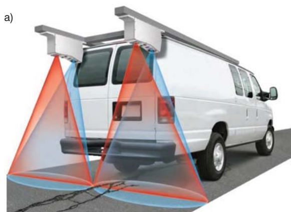
Fot. 15. a) Zestaw do pomiaru spękań nawierzchni; b) Widok ogólnej zasady działania systemu AON
