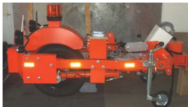
Fot. 24. Zestaw pomiarowy SRT-3 (punktowy pomiar współczynnika tarcia nawierzchni)
