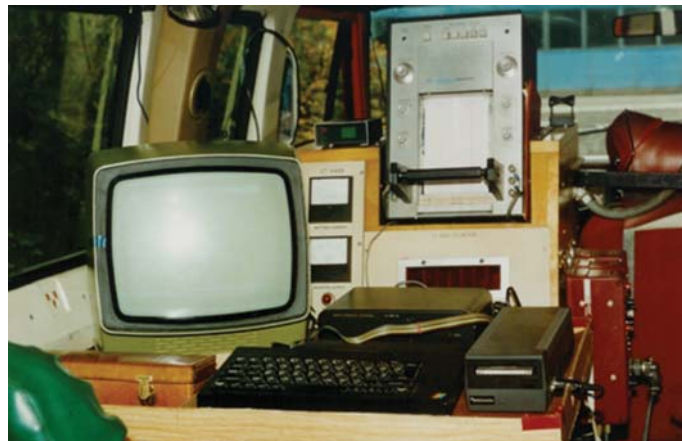
Fot. 21. Urządzenie przetwarzające dane z Klasyfikatora nawierzchni
