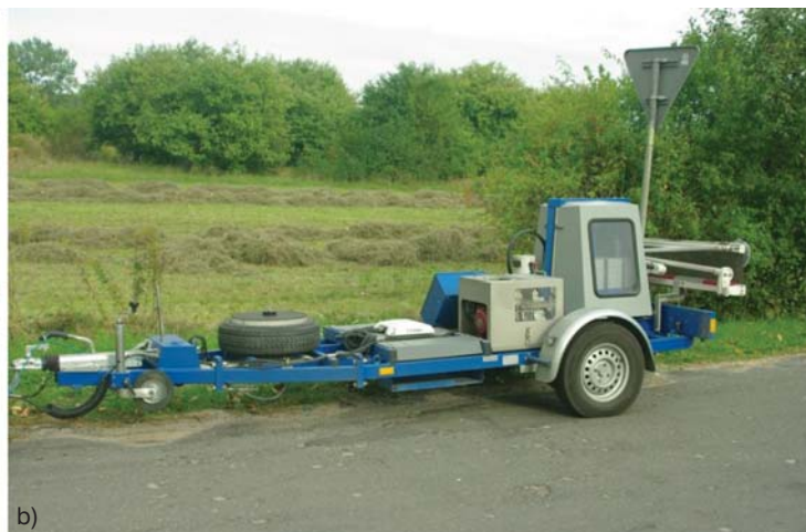
Fot. 27. Zestawy pomiarowe FWD (punktowy pomiar ugięć konstrukcji nawierzchni): a) produkcji firmy Kuab; b) produkcji firmy Dynatest
