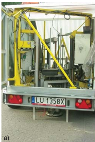
Fot. 27. Zestawy pomiarowe FWD (punktowy pomiar ugięć konstrukcji nawierzchni): a) produkcji firmy Kuab; b) produkcji firmy Dynatest
