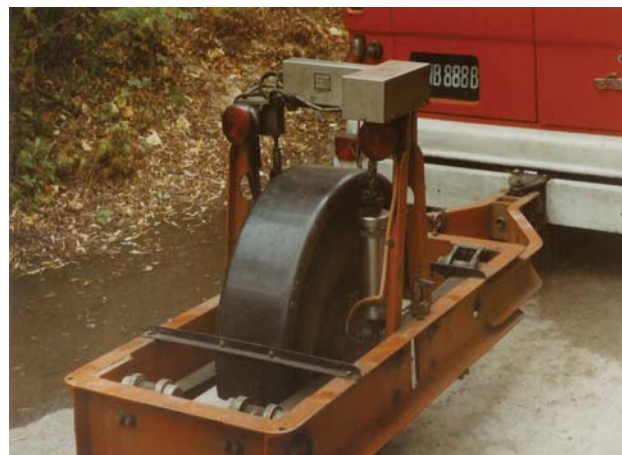
Fot. 20. Zestaw pomiarowy Bump Integrator (Klasyfikator nawierzchni)
