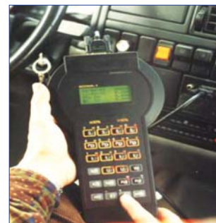
Fot. 13. Rejestrator Sowa-1 do półautomatycznej oceny stanu nawierzchni jezdni
