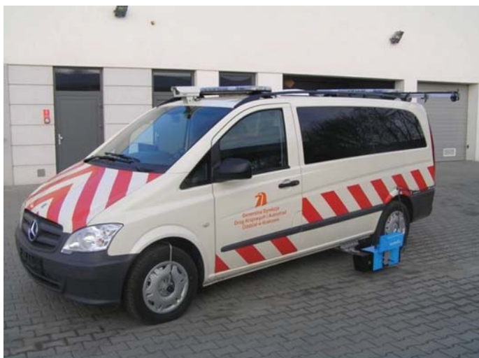
Fot. 26. Zestaw pomiarowy RMT (ciągły pomiar oznakowania poziomego nawierzchni)
