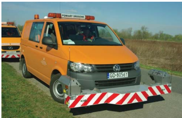
Fot. 19. Profilograf RSP wyposażony w 21 czujników laserowych oraz odbiornik GPS
