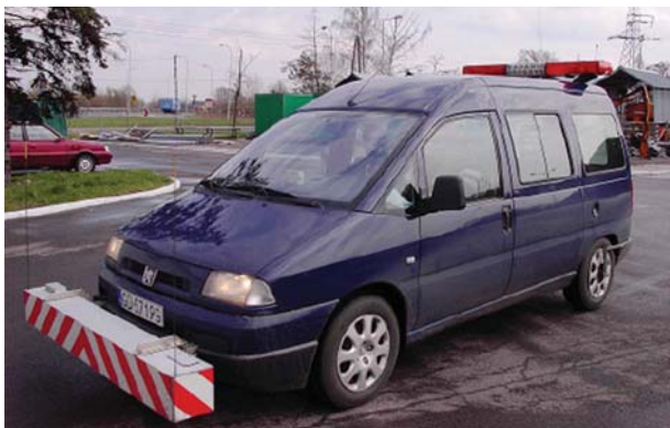
Fot. 18. Profilograf RSP wyposażony w belkę z kilkoma czujnikami laserowymi
