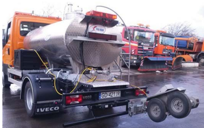
Fot. 25. Zestaw pomiarowy TWO (ciągły pomiar współczynnika tarcia nawierzchni)
