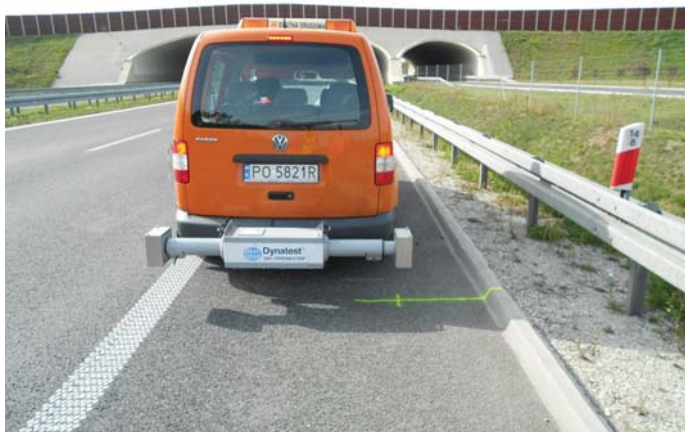
Fot. 23. Profilograf RSP wyposażony w 1 czujnik laserowy
