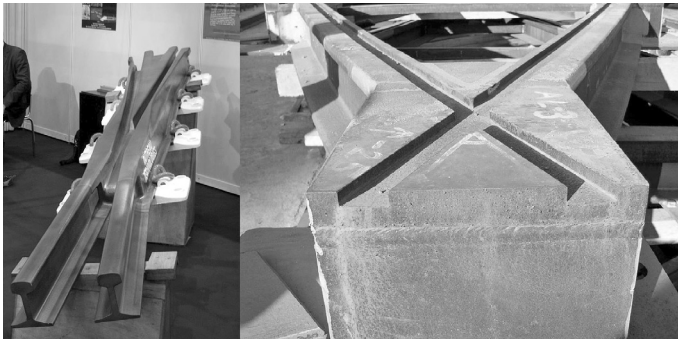
Fot. 4. Porównanie krzyżownicy typu kolejowego i tramwajowego
