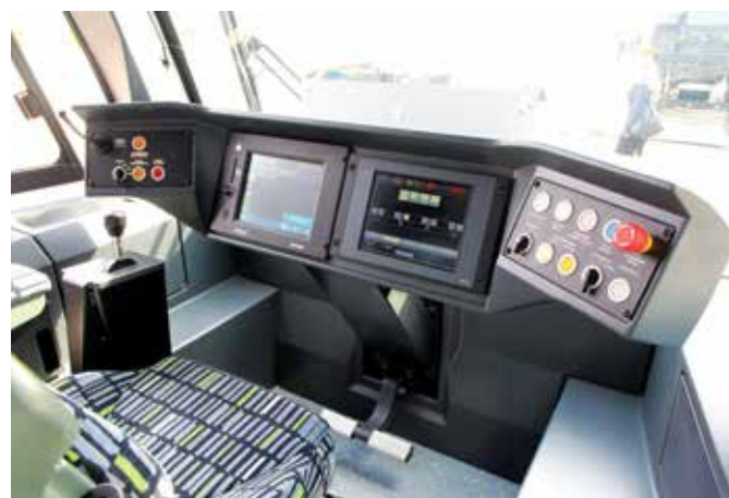
Pulpit motorniczego w tramwaju Solaris Tramino dla Olsztyna
