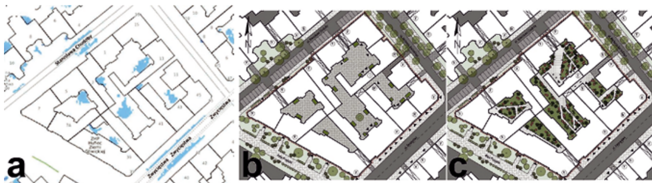
Rys. 7. Etapy wdrażania rozwiązania: a – etap 1., analiza miejsc zalewanych; b – etap 2. i 3. – lokalizacja zbiorników na deszczówkę i ogrodów deszczowych; c – etap 4. – ogrody deszczowe w gruncie i zieleni wewnątrzkwartalowa; źródło: Patrycja Baran
