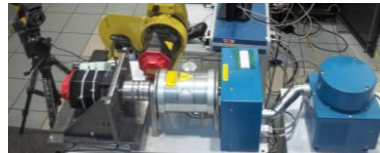
Rys. 2. a) Widok ogólny systemu NI PXIe-1075 z zastosowanymi kartami pomiarowymi; b) Widok ogólny badanego silnika robota oraz hamulca histerezy MAGTROL HD-715
