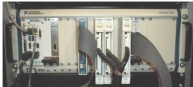
Rys. 2. a) Widok ogólny systemu NI PXIe-1075 z zastosowanymi kartami pomiarowymi; b) Widok ogólny badanego silnika robota oraz hamulca histerezy MAGTROL HD-715
