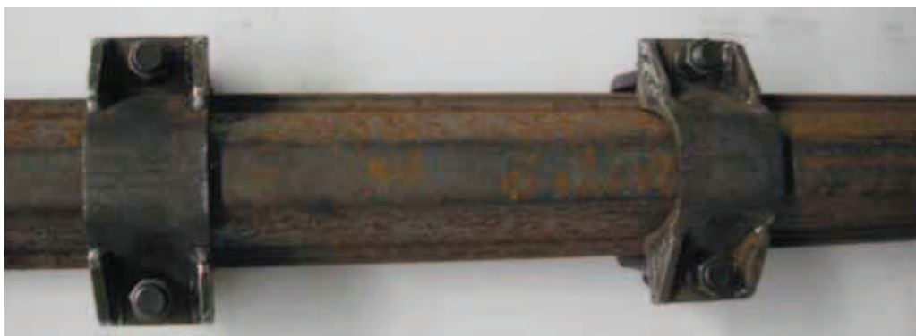
Rys. 1. Widok złącza ciernego z dwoma strzemionami typu SDO29w Fig. 1. View of frictional joint with two stirrups SDO29w
