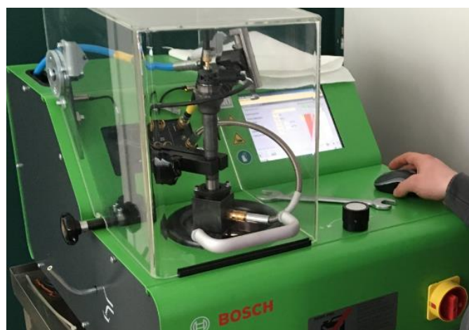
Fot.8. Laboracyjne stanowisko badawcze EPS202A
