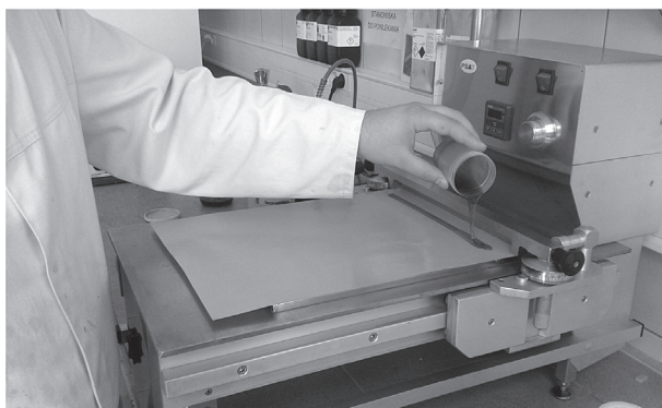
Rys. 2. Powlekanie próbek do badania adhezji rozpuszczalnym w wodzie klejem samoprzylepnym
