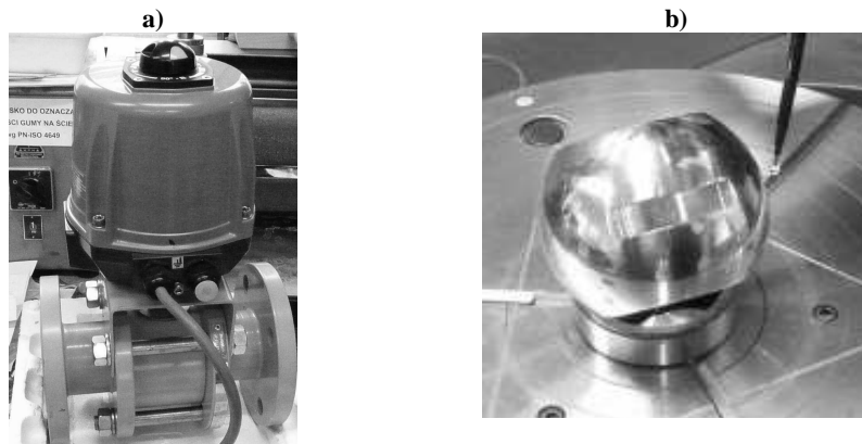
Rys. 4a. Badany zawór, 4b. Kula podczas pomiarów chropowatości
