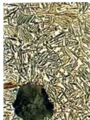
Rys. 12. Mikrostruktura ausferrytu we wlewkę o grubości 50 mm
