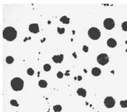
Rys. 9. Grafیت w żeliwie wyjściowym przed obróbką cieplną. Wlewek 50 mm. Pow. 100×, nietraw.
