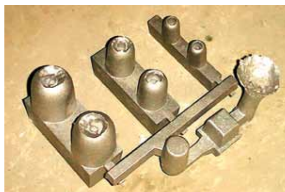
Rys. 3. Odlew zestawu wlewków o grubościach 25 mm, 50 mm i 75 mm
