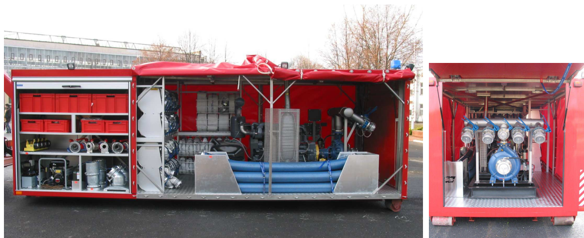
Fot. 4. Kontener z pompą dużej wydajności (producent: Wawraszek - Inżynieria Samochodów Specjalnych)
