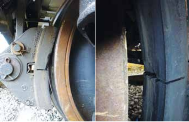
Fot. 3. Widok kompozytowej wstawki hamulcowej z wylupaniem materiału ciernego
