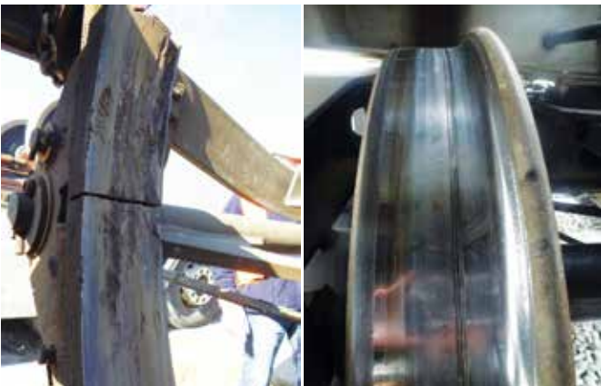
Fot. 4. Widok wstawki hamulcowej z ubytkami materiału ciernego powstałymi po wypadnięciu wtrąceń metalicznych oraz widok koła z rysami obwodowymi powstałymi po współpracy z kompozytowymi wstawkami hamulcowymi posiadającymi wtrącenia metaliczne
