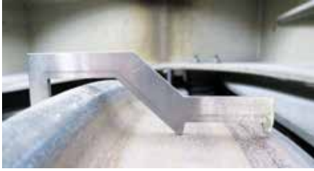
Fot. 2. Widok szablonu do kontroli zużycia wgłębnego profilu powierzchni tocznej kół
