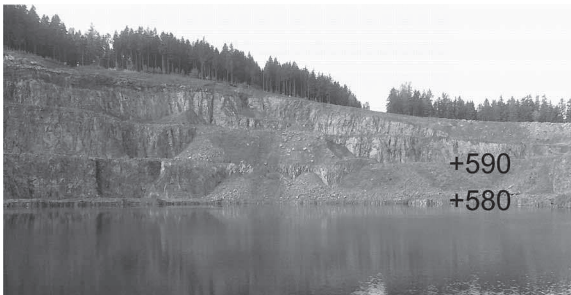
Rys. 9. Wysokość zwierciadła wody w wyrobisku poeksploatacyjnym kopalni Świerki II – wrzesień 2013 r. Fig. 9. Level of water mirror in Świerki II – September 2013
