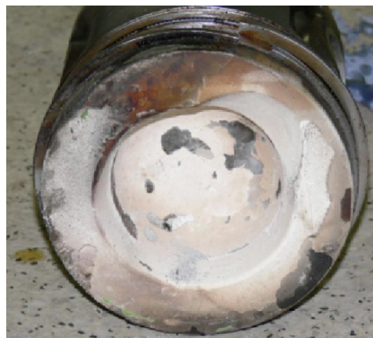
Rys. 5.1.: a) Głowica silnika z warstwą osadów siloksanów, b) osady siloksanów na tłoku silnika [17]
