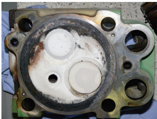
Rys. 5.1.: a) Głowica silnika z warstwą osadów siloksanów, b) osady siloksanów na tłoku silnika [17]
