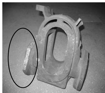
Rys. 1. Uszkodzony odlew z żeliwa wysokokrzemowego z widocznym „zabieleniem” na przelomie uszkodzonej ścianki
