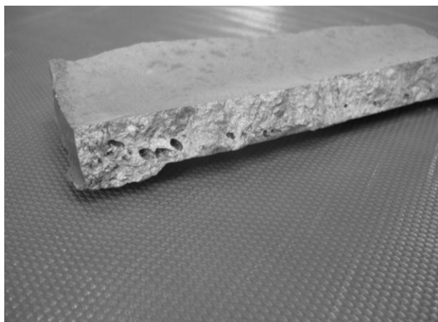
Rys. 2. Zabieleny przełom uszkodzonej ścianki odlewu z widoczną porowatością gazową
