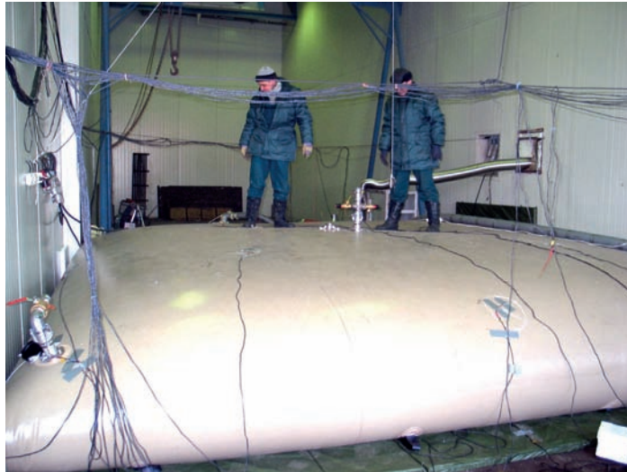
Badania prototypowego zbiornika wody (Zlec. WITI Wrocław 2006)
