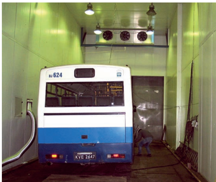
Badania silnika autobusu zasilanego paliwem eksperymentalnym na biokomponentach (Zlec. WSiMR PW Warszawa 2016)
