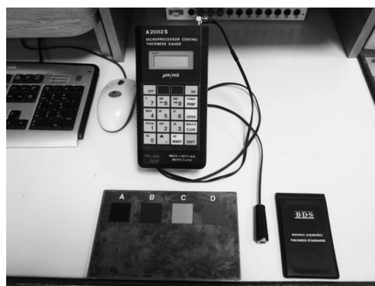
Rys. 2. Widok warstwomierza oraz zestawów powłok mierzonych i referencyjnych przygotowanych do realizacji ćwiczenia
