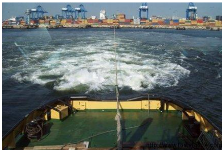
Rys. 4. Test holownika badający siłę uciągu na palu [9]
