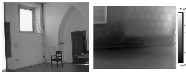
Rysunek 4.1 Fotografia i termogram wnętrza budynku
