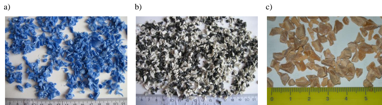
Rys. 3.1. Granulat uzyskany z odpadów poprodukcyjnych w pierwszym etapie rozdrobnienia a) polietylen, b) polipropylen, c) polichlorek winylu (wyk. własne).
