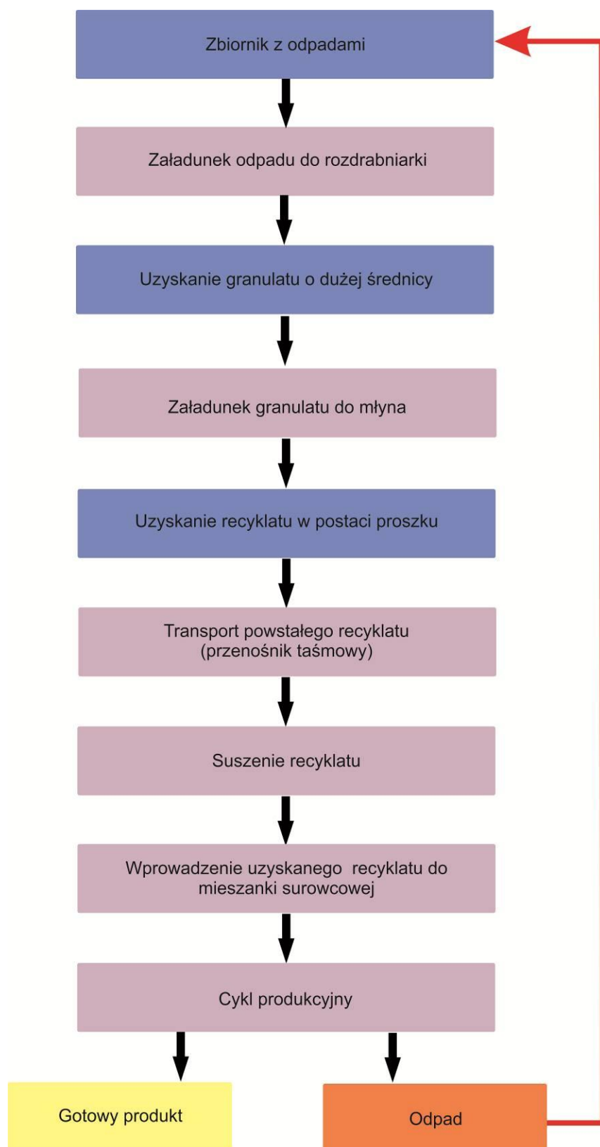
Rys. 3.2. Uproszczony schemat systemu recyklingu materiałowego w zakładzie[21].
