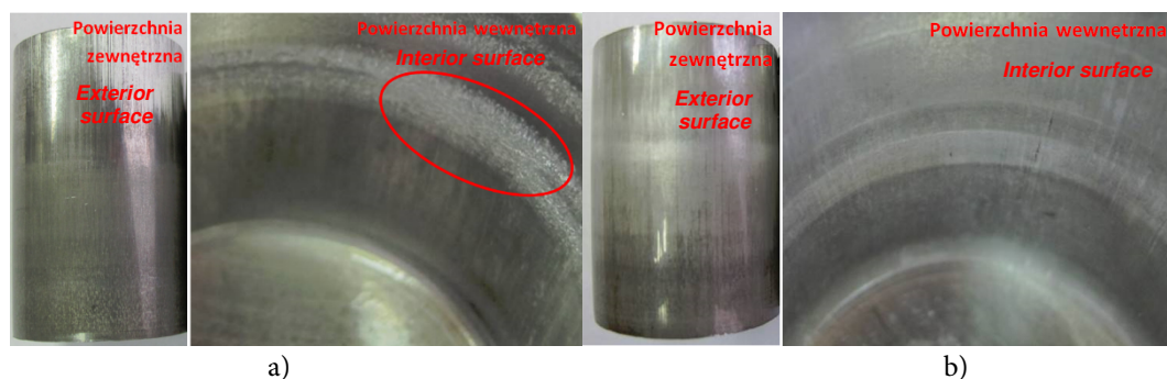
Rys. 11. Wypraski po międzyoperacyjnym przesycaniu poddane procesowi wyciągania ścianki przez trzy matryce, smarowane: a) olejem multipress Al71, b) stearynianem cynku
