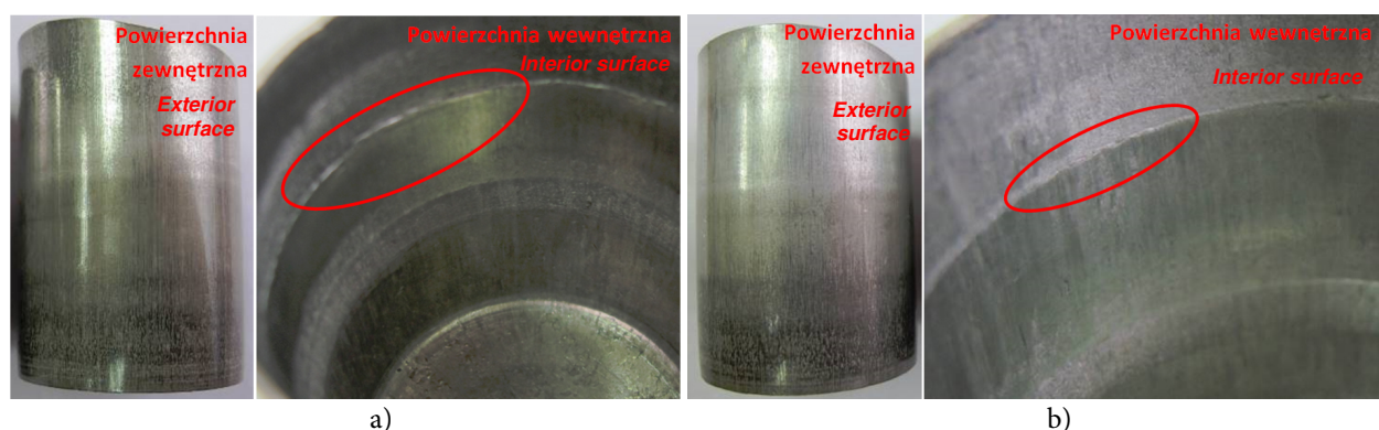
Rys. 9. Wypraski po międzyoperacyjnym przesycaniu poddane procesowi wyciągania ścianki przez dwie matryce, smarowane: a) olejem multipress Al71, b) stearynianem cynku
