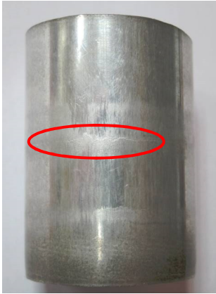
Rys. 1. Nieciągłość na powierzchni zewnętrznej po ostatniej operacji wyciągania ścianki
