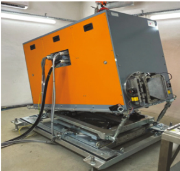
Rys. 2. Dwuenergetyczny akcelerator liniowy CANIS.
