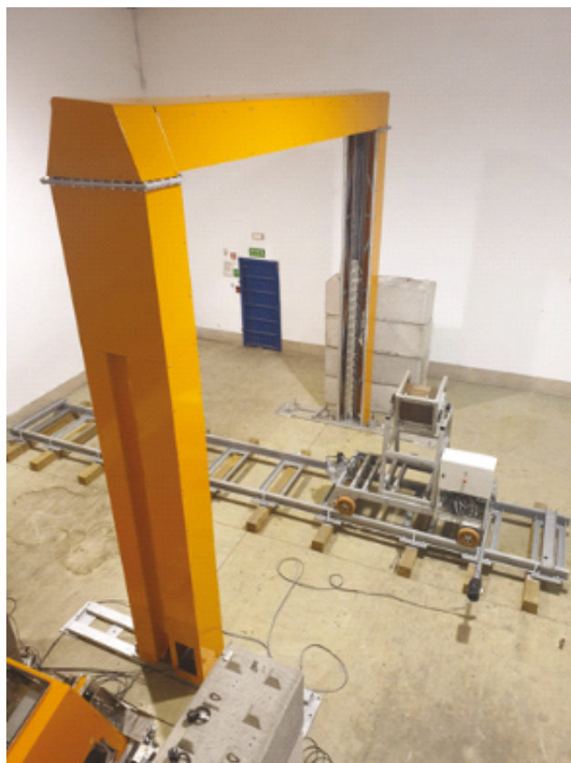
Rys. 10. Zdjęcie stanowiska pojazdu testowego na torowisku, umieszczonego w przelocie skanera.
