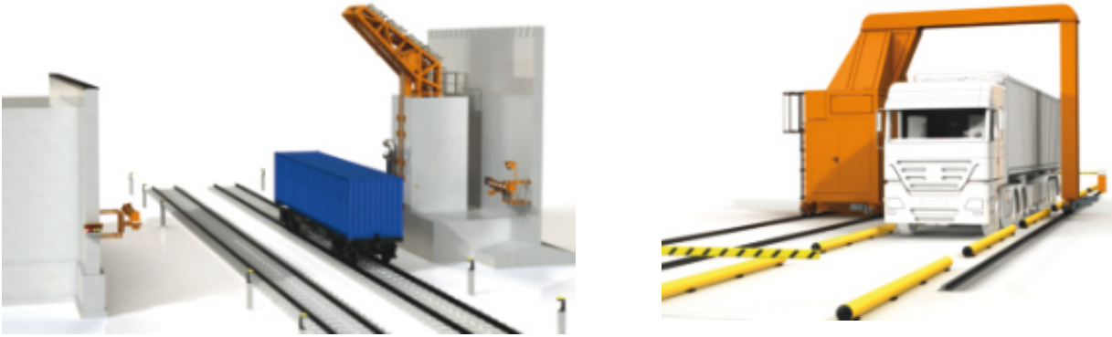
Rys. 1. Wizualizacja systemu MultiControl CANIS RAIL oraz MultiControl CANIS GANTRY / PORTAL.
