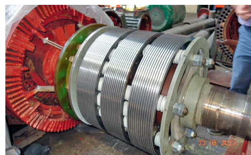
Rys. 9. Widok na wyremontowaną głowicę silnika pierścieniowego z widocznymi nowymi elementami łączeniowymi z uzwojeniem wirnika [opr. wł.]
