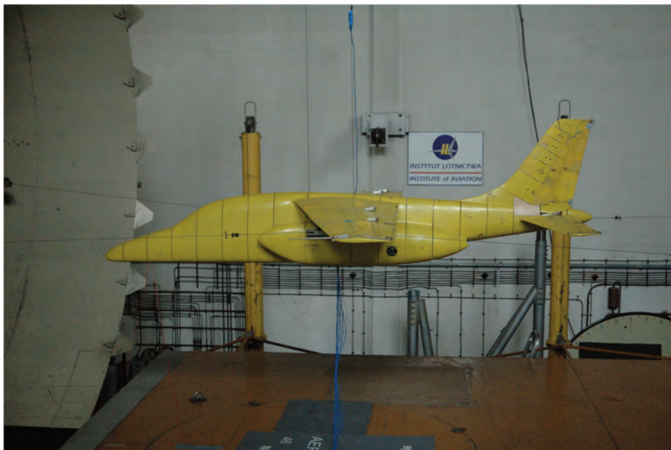
Fot. 1,2 i 3. Model samolotu w tunelu aerodynamicznym
