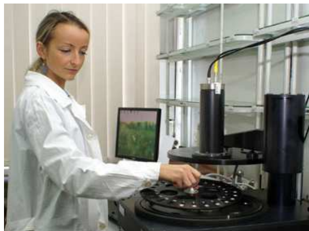
Fot. 3. Urządzenie do identyfikacji napromieniowania artykułów spożywczych metodą termoluminescencji - czytnik RISØ TL/OSL-DA-20
