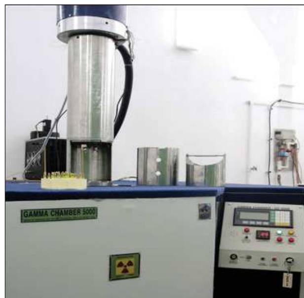
Fot. 1. Wygląd zewnętrzny źródła kobaltowego Gamma Chamber 5000 Photo.1. The cobaltic source - Gamma Chamber 5000
