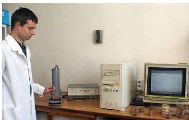
Fot. 2. Aparat do badania napromieniowania przypraw roślinnych metodą luminescencji stymulowanej impulsami światła - urządzenie SURRC Irradiated Food Screening System
