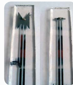
Rys. 5. Prototypy czujników pola elektromagnetycznego na paśmie 60-90 GHz, skonstruowane w LWiMP
