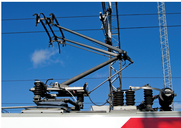
Pantograf zespołu Sm3 jest także wyposażony w mechanizm przechyłu, działający w przeciwną stronę w stosunku do przechyłu nadwozia Fot. M. Graff
