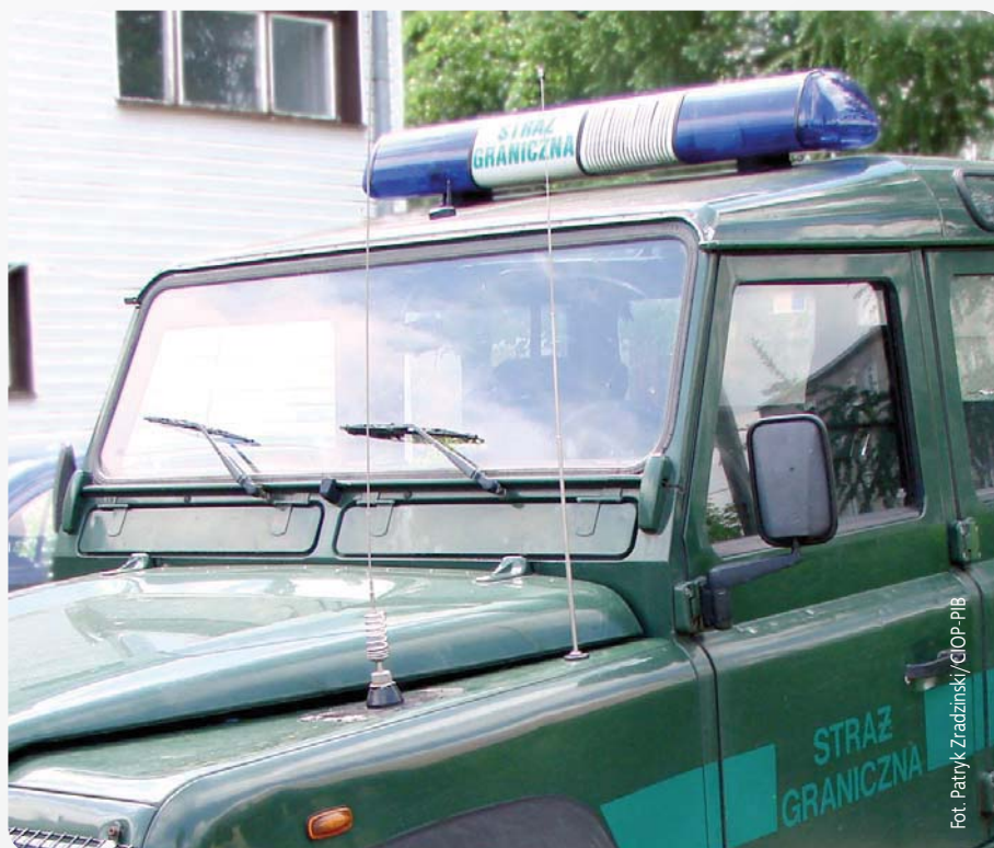
Fot. Przykładowa lokalizacja różnego typu anten radiotelefonów przewoźnych na nadkolu samochodu terenowego straży granicznej: spiralna (z lewej) i prętowa
