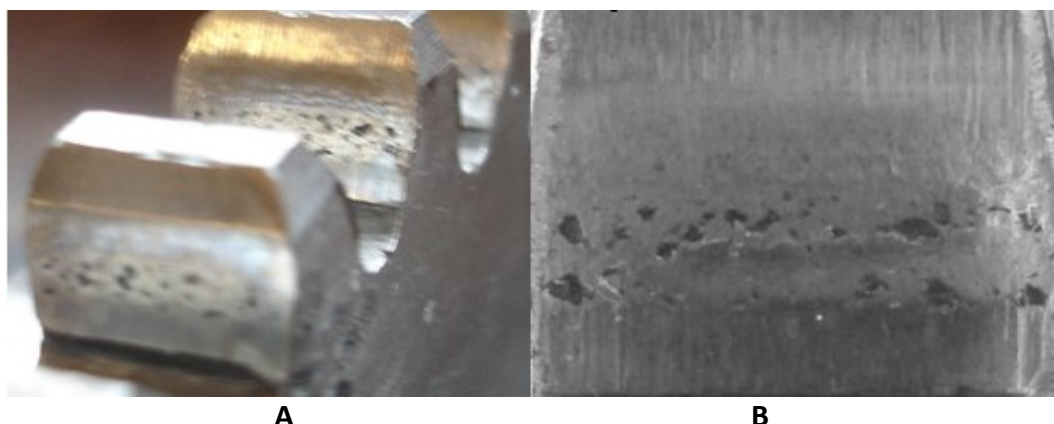
Rys. 5. Widok powierzchni badanego kola zębatego: a) widok ogólny zniszczonych powierzchni zębów, b) zniszczona powierzchnia w powiększeniu
