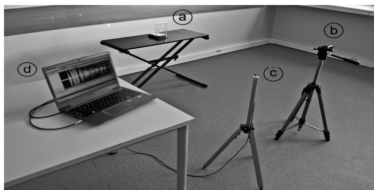
Rys. 3 . Widok wykorzystanego w badaniach układu mikrofonu laserowego: a) membrana, b) wskaźnik laserowy, c) fotodetektor, d) urządzenie rejestrujące
