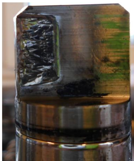
Rys. 15. Uszkodzenie płetwy wałka napędowego pompy wysokiego ciśnienia firmy Siemens
