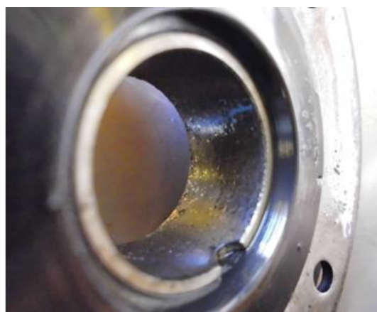
Rys. 16. Zużycie ściernie powierzchni ślizgowej i wykruszenie fragmentu panewki wałka napędowego pompy wysokiego ciśnienia firmy Siemens
