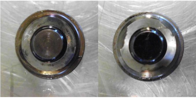
Rys. 7. Zużycie ścierne zaworków sekcji pompy wysokiego ciśnienia Bosch typu CP3
