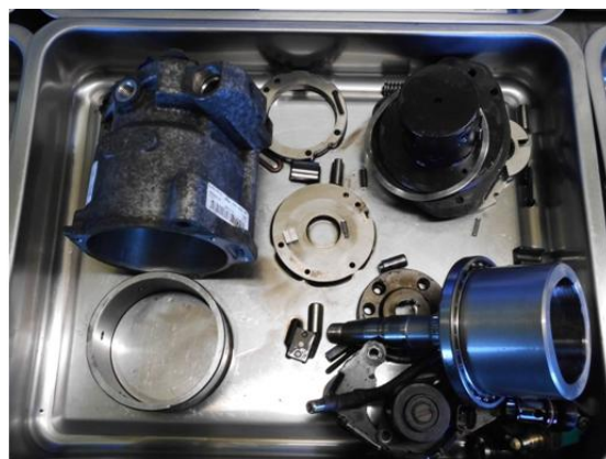
Rys. 4. Widok po demontażu pompy wysokiego ciśnienia firmy Delphi
