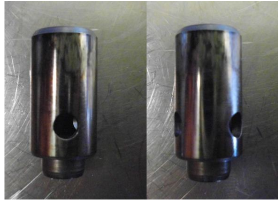
Rys. 10. Zużycie ścierne zaworka ciśnienia wewnętrznego w pompie wysokiego ciśnienia Delphi
