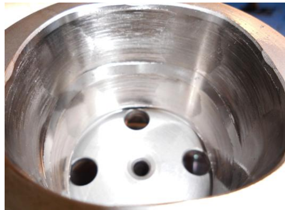
Rys. 12. Wyraźne ślady zużycia ściernego bieżni rolek w koszu pompy wysokiego ciśnienia Delphi
