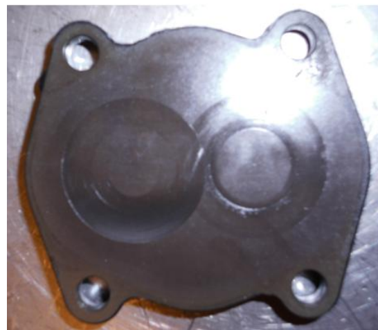
Rys. 6. Zużycie ściernie pokrywy pompy wstępnej z pompy wysokiego ciśnienia Bosch typu CP3
