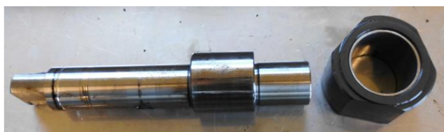
Rys. 14. Zużycie ściernie wałka napędowego pompy wysokiego ciśnienia firmy Siemens
