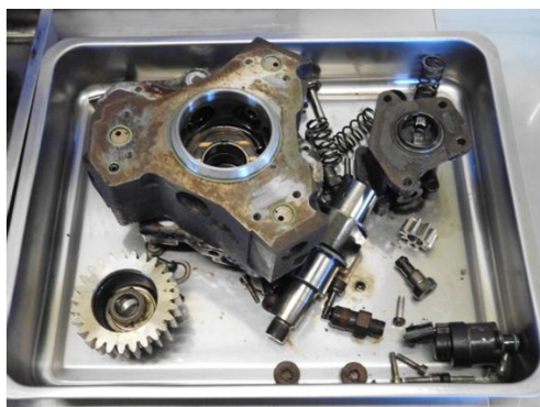
Rys. 3. Widok po demontażu trójtłoczkowej, promieniowej pompy wysokiego ciśnienia firmy Bosch typu CP3 stosowanej w samochodach ciężarowych firmy MAN
