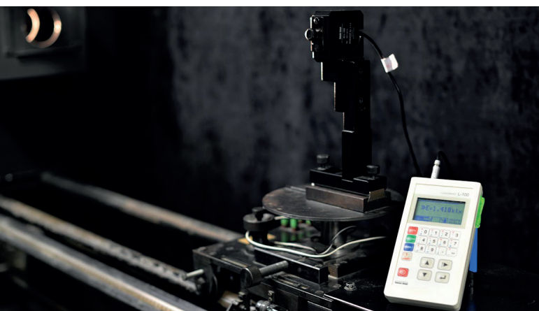
Rys. 6. Ława fotometryczna do wzorcowania luksomierzy
