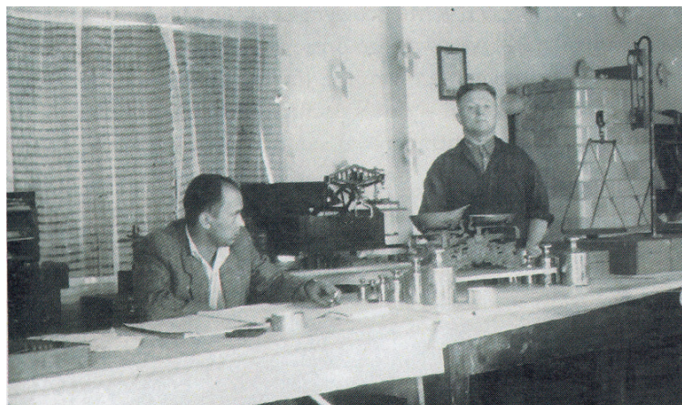
Rys. 3. Objazdowy Urząd Miar w Suwałkach. Widoczny zestaw wag i odważników. Na pierwszym planie na wypoziomowanej płycie sprawdzana jest waga szalkowa klienta, obok waga legalizacyjna dla odważników handlowych, z tytu waga podróżna Rueprechta w położeniu roboczym
