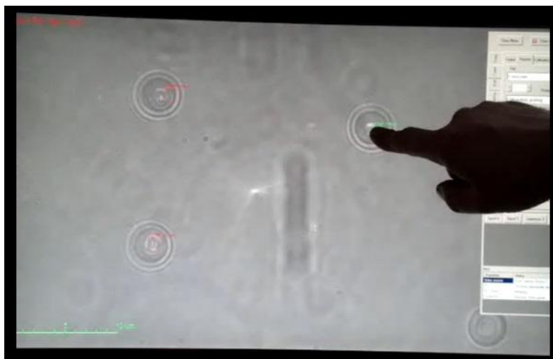
Rys. 5. Zdjęcie panelu dotykowego. Pułapki mogą być przemieszczane poprzez dotknięcie powierzchni panelu (w miejscu generacji pułapki) i przesunięcie go w żądane położenie
