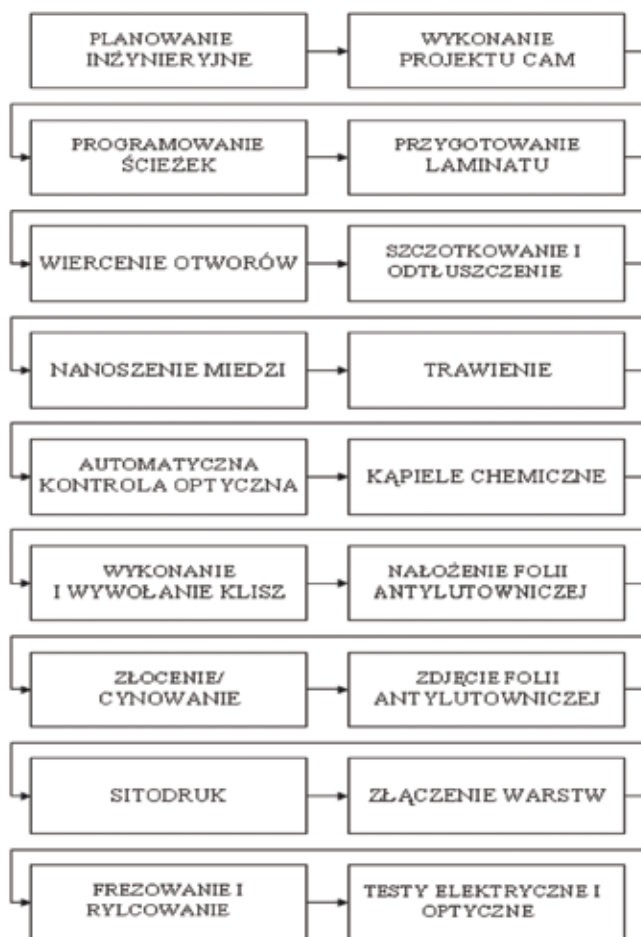
Rys. 3. Schemat procesu produkcji PCB [2]
