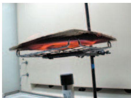
Fot. 2. Stanowisko badawcze zastosowane w I etapie badań – działanie płomienia palnika na próbkę
