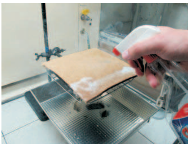
Fot. 4. Stanowisko badawcze w III etapie – gaszenie roztworem nanoszonym przy użyciu spryskiwacza
