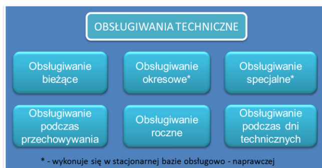
Rys. 1. Rodzaje obsługiwanego okresowego w zależności od celu i zakresu wykonywanego czynności
