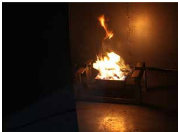
Rycina 6. Przykładowe badanie wg PN-EN 61034-2 w CNBOP-PIB
