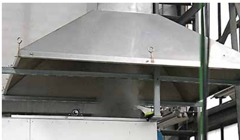
Rycina 7. Wydzielanie dymu przez kabel YnKYžo podczas badania wg PN-EN 50399
