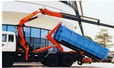
Rys. 1. Żuraw przenośny i dźwignik hakowy kontenerowy na podwoziu samochodu ciężarowego [1] Fig. 1. Truck crane and hookloader on a truck chassis [1]
