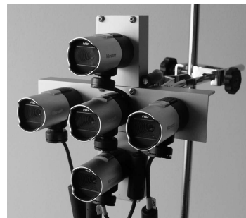
Rys. 1. Układ kamer o nazwie EBMCS (Equal Baseline Multiple Camera Set) użyty w eksperymentach
