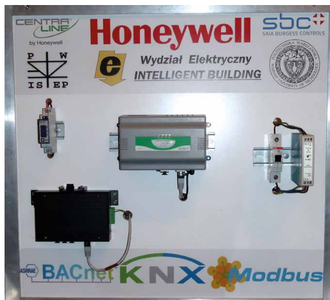
Rys. 4. Stanowisko pozwalające na integrację systemów BACnet, KNX i Modbus
