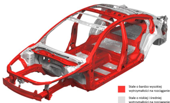
Rys. 3. Zastosowanie stali typu AHSS w przemyśle motoryzacyjnym [4] Fig. 3. Application of AHSS steel in the automotive industry [4]
