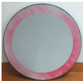
Fot. 1. Znak B-1 po 10 latach eksploatacji
