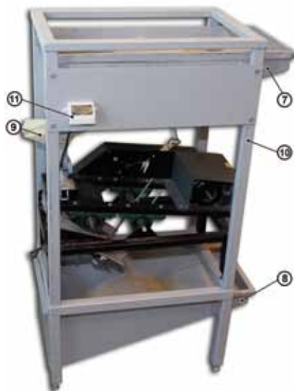
Rys. 10. Wygląd stanowiska do badań odporności na ścieranie erozyjne w wersji końcowej
