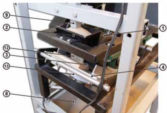
Rys. 11. Widok dystrybucji i drogi ścierniwa
