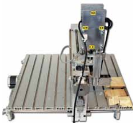
Rys. 13. Skanowanie powierzchni próbek po ścieraniu za pomocą prototypowego profilometru laserowego (konstrukcja i oprogramowanie własne)
